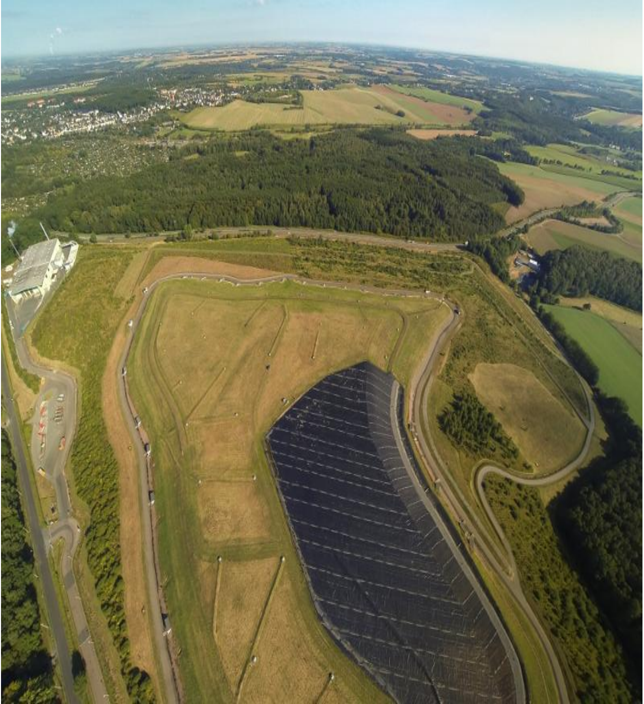
Bild 1: Standort Weißer Weg – Übersicht temporäre Abdichtung (2014)
